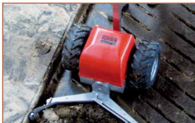
Breite Bereifung - Frostschutz befüllt
