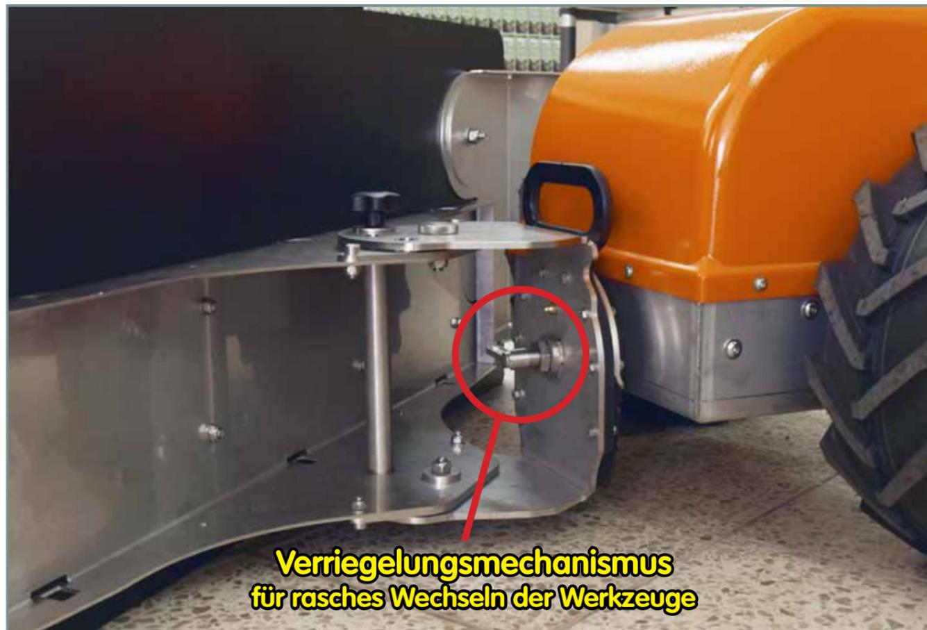
Die große Nachfrage nach einer noch flexibleren Maschine hat die Entwicklung eines einzigartigen Schnellwechselsystems hervor gebracht. Mit diesem ist es möglich unterschiedliche Werkzeuge mühelos und in Sekundenschnelle an das Grundgerät zu koppeln.
