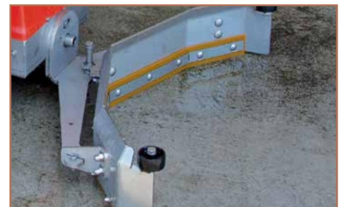
Reinigungsleiste aus Polyurethan (wendbar)
