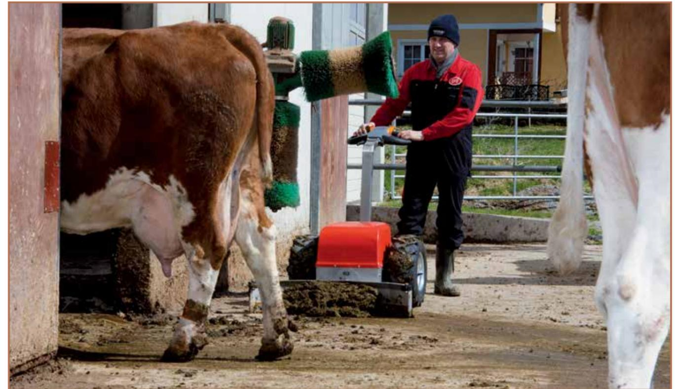
Kardanisch angebauter Schieber für optimale Bodenadaptation
