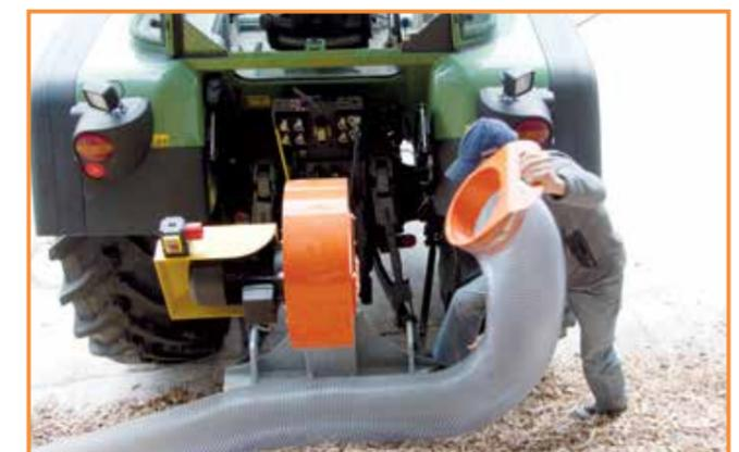
Schlauch mit Schnellwechselanschluss
