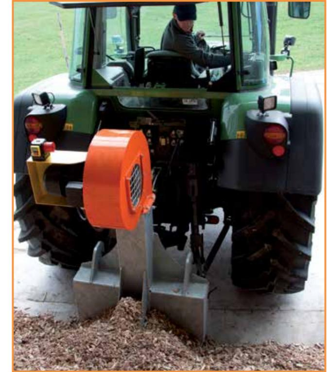
Hochleistungslüfter mit integriertem Schnellwechsler
