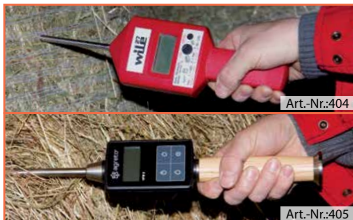
Heufeuchtemesser zur Kontrolle der Lagerfähigkeit
