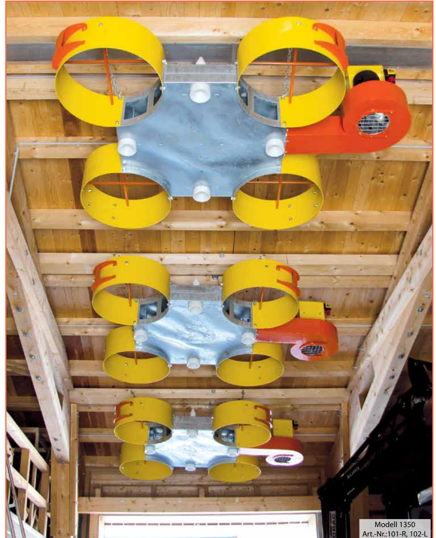
3 Belüftungsmodule Mod. 1350 für 24 Rundballen werden mittels Elektrowinde hochgezogen
