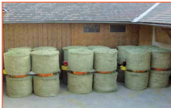
3 Belüftungsmodule für 24 Rundballen
