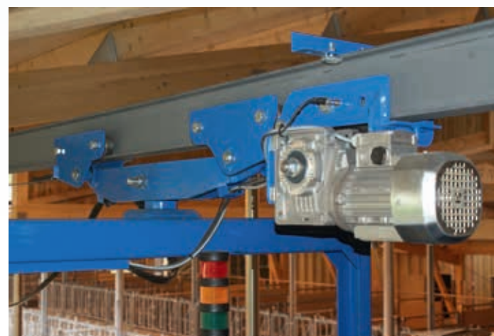
↑ Mit dem gut dimensionierten Spezialfahrwerk sind Kurven und Steigungen kein Problem.
