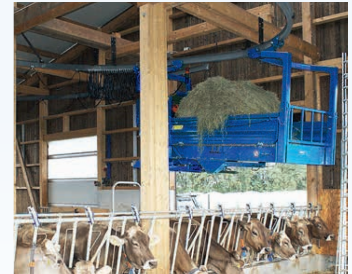
↑ Die Maschine kann universell eingesetzt werden, da Kurven und Steigungen möglich sind.
