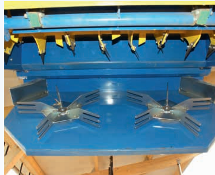
↑ Mit der Breistreueinrichtung kann das Stroh bis zehn Meter breit verteilt werden.
