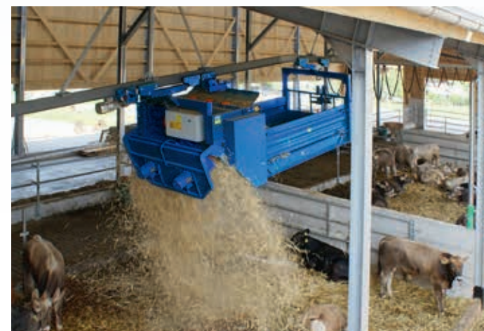
↑ Die Ausbringmenge kann über Funk gesteuert werden.
